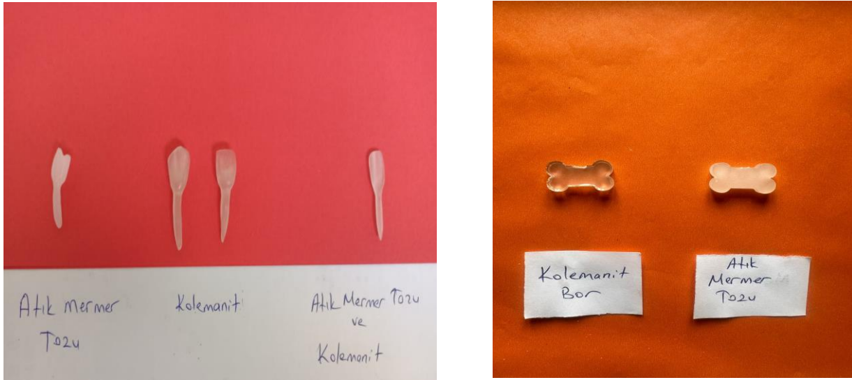
Şekil 6. Epoksi reçineye atık mermer tozu ve kolemanit katkılı protez kemik ve dişler
